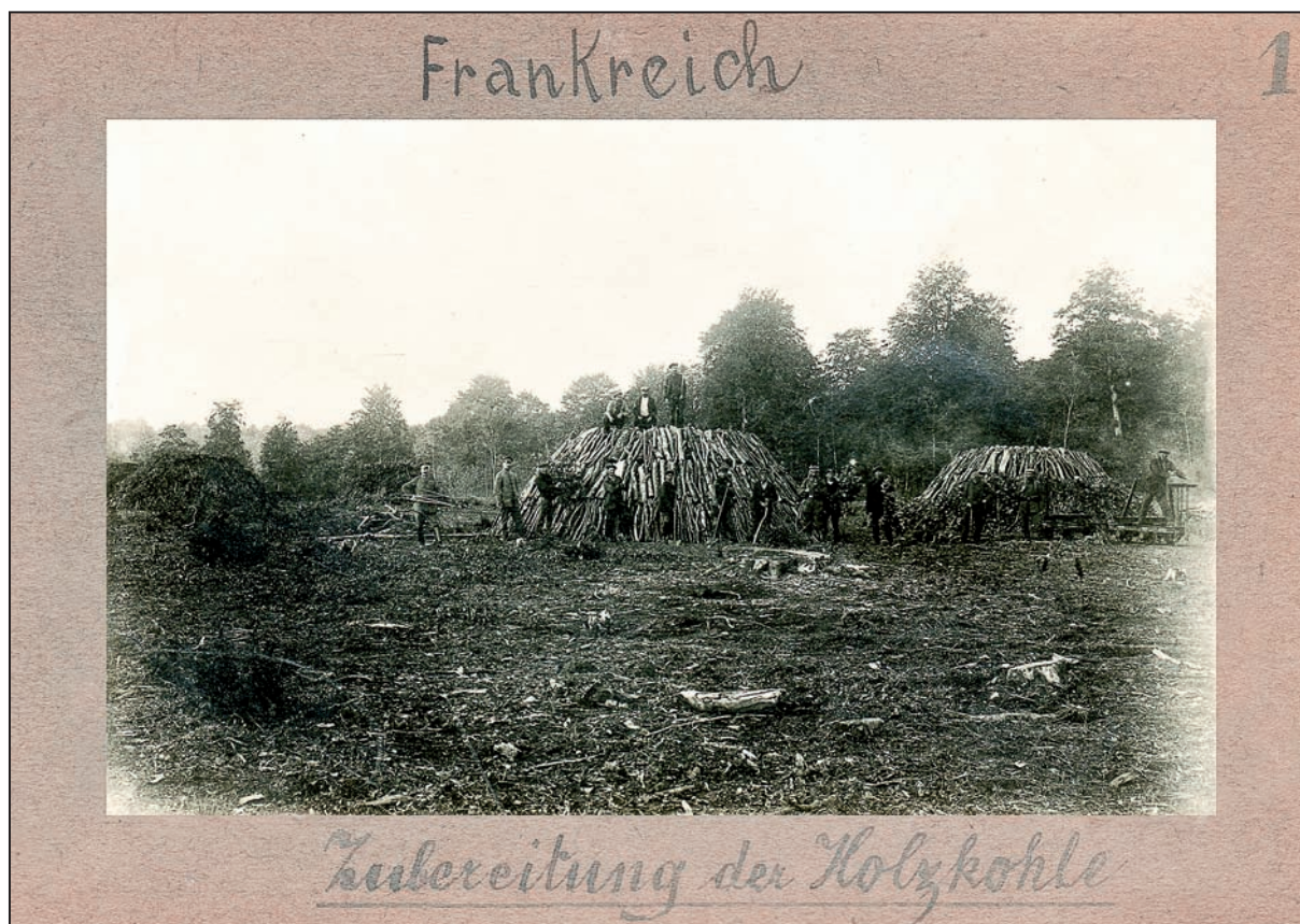
“Zubereitung der Holzkohle” – Préparation du charbon de bois. Présentation de la carte photo placée sur la première page de l’album du “Lagerkommandant” RAU (collection R. Martinois). L’officier allemand pose pour la photo sur la gauche de la meule en cours de préparation au centre du cliché. À côté de lui se trouve l’adjudant qui le seconde pour diriger le camp forestier. Les charbonniers au travail sont exclusivement des prisonniers belges.
